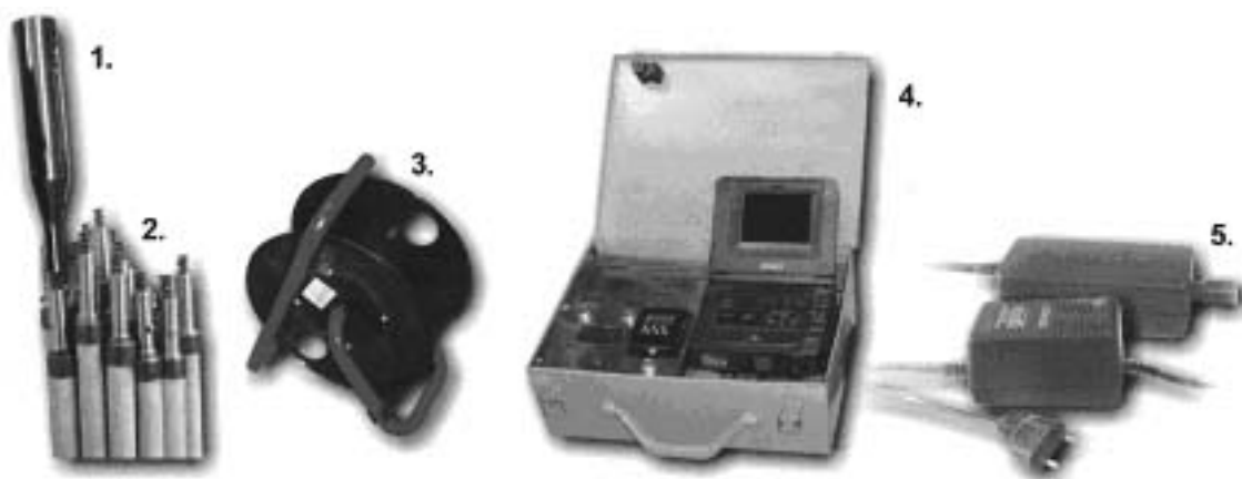
1- объектив, преобразователь изображения, 2 – наборной досыльник, 3 – бухта с кабелем, 4 – модуль регистрации и накопления видео информации, 5 – блоки питания.
